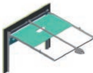
3 Portão em fase de abertura
